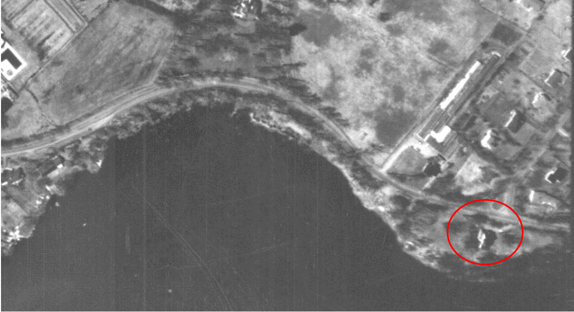
Figure 14. Extrait d'une photographie aérienne de 1964. On y observe notamment la poursuite des travaux d'aménagement et de remblayage des berges. À noter que les arbres matures visibles sur la photographie aérienne de 1948, aux abords immédiats de l'hôtel de ville sont toujours visibles, ce qui indique qu'à cette date aucun remblai majeur n'a été apposé à cet endroit.
