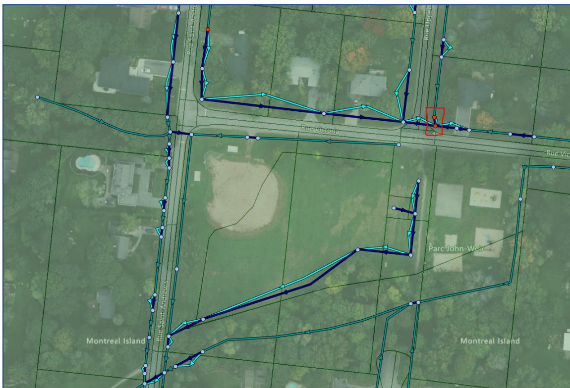
Figure 27 : Scénario 1 - Débordements intersection Victoria/Upper Cambridge (nœud R1435)
