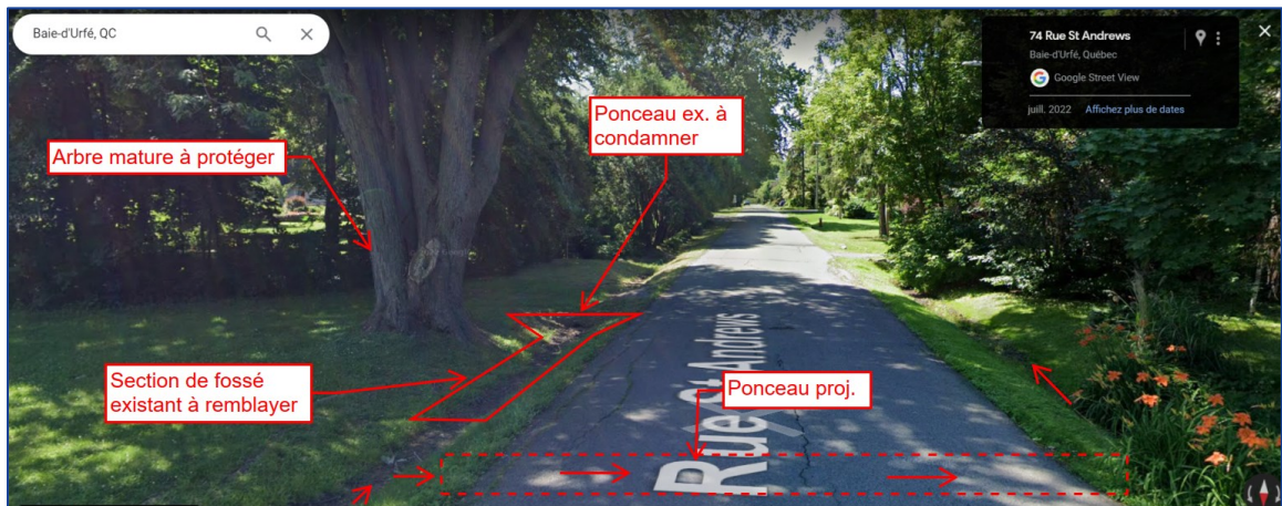
Figure 48 : Piste d'optimisation pour préservation d'un arbre mature
