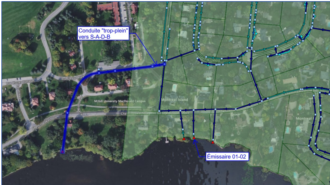
Figure 33 : Conduite trop-plein vers Sainte-Anne-de-Bellevue – Vue en plan
