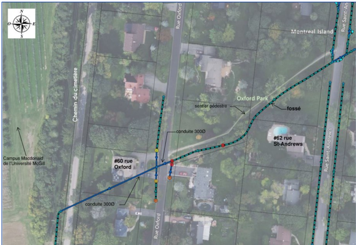
Figure 3 : Localisation de la problématique de drainage, résidence #60 rue Oxford (Étude hydraulique, EXP)
